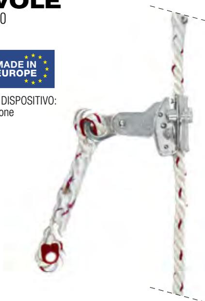
SI SPOSTA LUNGO LA PROPRIA LINEA DI ANCORAGGIO, ACCOMPAGNANDO L'UTILIZZATORE SENZA BISOGNO DEL SUO INTERVENTO MANUALE DURANTE GLI SPOSTAMENTI VERSO L'ALTO O VERSO IL BASSO E SI BLOCCA AUTOMATICAMENTE SULLA LINEA DI ANCORAGGIO IN CASO DI CADUTA PROVOCANDO LA RELATIVA DISSIPAZIONE D'ENERGIA.
