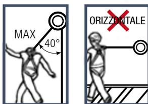
DISPOSITIVO DOTATO DI FRENATURA AUTOMATICA AD INERZIA.
